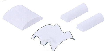
1. Parete Nord, incontro tra le volte a botte che generano le unghie 2. Parete Est, unghia 3. Soffitto, disposizione mattoni in corrispondenza dell'unghia
