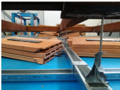
Fotografia della superficie d'estradosso dell'oggetto dopo l'urto n. 1
