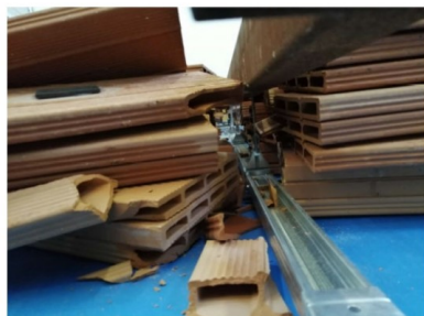
Fotografia della superficie d'estradosso dell'oggetto dopo l'urto n. 6
